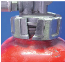
× キャップの破損
