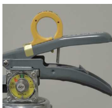
× レバー支えの脱落
