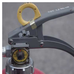
× 表示装置の脱落
